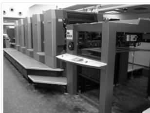
Ugyanez az elv az alapja a bádognymtatásnak is, melyet plakátgyártásnál, konzervdoboz gyártásnál használtak. Szintén ebből fejlődött ki a ma leginkább elterjedt ofszetnyomtatás, mely szintén egy közvetett nyomtatási forma.
